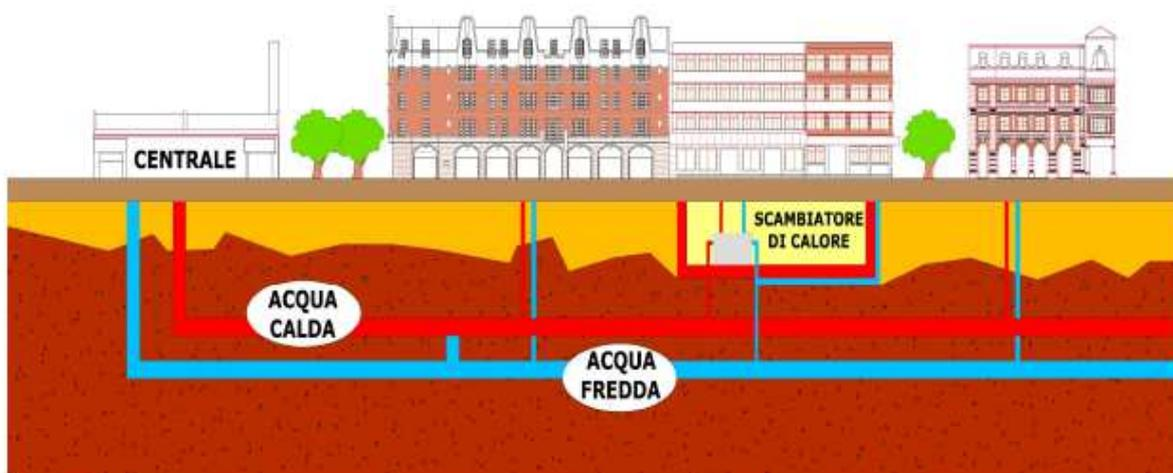
Figura 1: Schema per un impianto di teleriscaldamento
