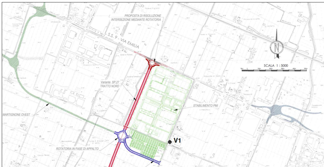
Img. 5.1.1.3 - Progetto viabilità di collegamento tra il nuovo svicolo autostradale e S.S.9 "Via Emilia" e viabilità del Polo Industriale Martignone
